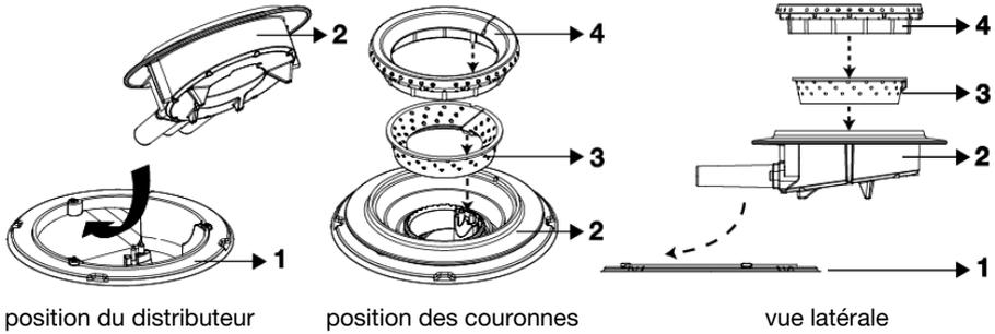
Positionnez correctement les pièces du brûleur pour wok. Un placement incorrect des pièces du brûleur risque de nuire au fonctionnement de ce dernier.
