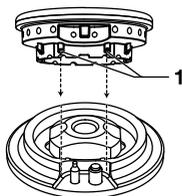
Suivez les encoches d'assemblage pour assembler les brûleurs (1).
