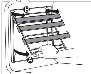
**A** Приподнимите направляющие снизу, отведя их от стенки.
