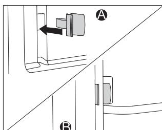
При установке полностью выдвигающихся телескопических направляющих с вкладышами EasyClean установите фиксаторы (прилагаются в комплекте) в отверстия в нижней части боковых стенок духовки. Зашелкните направляющие в фиксаторах. Фиксаторы обеспечивают более прочную установку направляющих.
