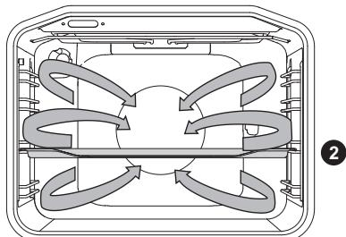
Одновременно работают нагревательный элемент вокруг вентилятора и вентилятор. Вентилятор создает постоянную циркуляцию горячего воздуха вокруг мяса или выпечки.
