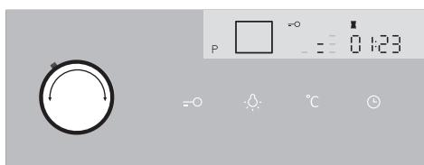
**3** Через некоторое время после начала пиролитической очистки для обеспечения безопасности дверца духовки автоматически заблокируется. На дисплее загорится символ «ключ».
