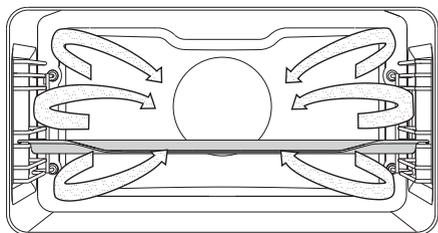
La vapeur d'eau produite par le générateur pénètre dans la cavité du four.
