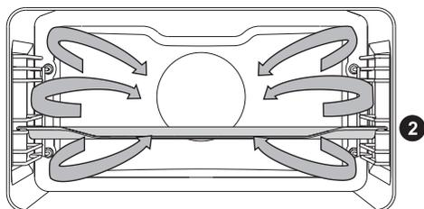
La résistance circulaire et le ventilateur fonctionnent simultanément. Le ventilateur situé au fond du four fait circuler autour du rôti, des légumes, ou du gâteau la chaleur produite par la résistance circulaire.
