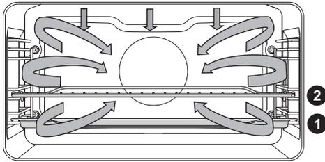
Dans le mode Rôtissage Auto, la résistance de voûte, le grill et la résistance circulaire fonctionnent simultanément. Ce mode de cuisson convient à tout type de viande à rôtir.
