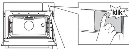
**1** Ouvrez la trappe du réservoir en appuyant sur l'autocollant.
