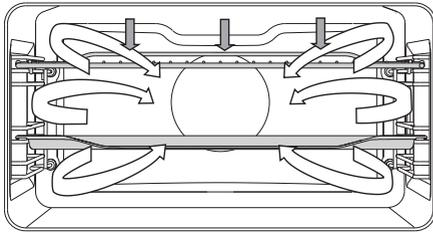
Le grill infrarouge et le ventilateur fonctionnent simultanément. Ce mode convient à la cuisson de la viande, du poisson et des légumes.
