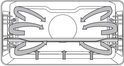
La résistance de sole, la résistance circulaire et le ventilateur fonctionnent en même temps. Ce mode convient aux pizzas et tartes aux fruits.
