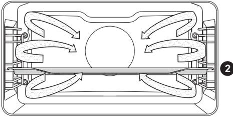
La vapeur d'eau produite par le générateur pénètre dans la cavité du four. De plus, la résistance circulaire et le ventilateur qui fonctionnent en même temps font circuler en permanence l'air chaud et la vapeur.
