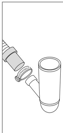
排水管最长可延伸到 3 米 (排水管的总长度不得超过 4.5 米)。所有转接或连接管的内径必须至少为 14 毫米。不过，最理想的方式是将排水管更换新的，并且不使用接头。
