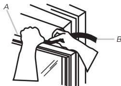
A A felső ablakszárny teteje B Tömítőszalag
