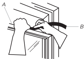
A. Zgornji del spodnjega okenskega okvirja B. Penasto tesnilo
