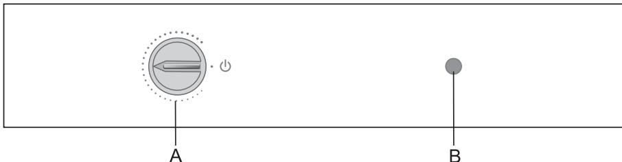
A Gumb za nastavitev temperature in vklop/izklop aparata
