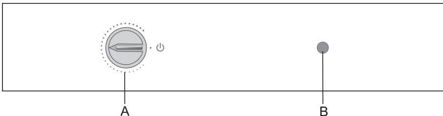
A Ovládací kolečko pro nastavení teploty a zapnutí/vypnutí
