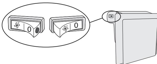
Provoz větráku a ionizátoru indikuje červené signální světlo na spínači.
