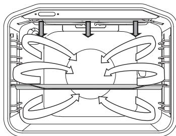
Одновременно работают верхний нагревательный элемент, инфранагреватель и вентилятор.
