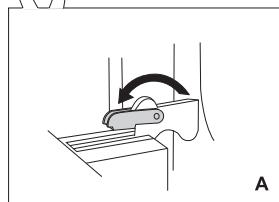
**2** **A** Откиньте фиксаторы до конца назад (при обычном закрывании дверцы).
