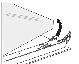
**2** Возмите стекло дверцы за нижний край, немножко приподнимите, чтобы оно освободилось из фиксаторов, и снимите.
