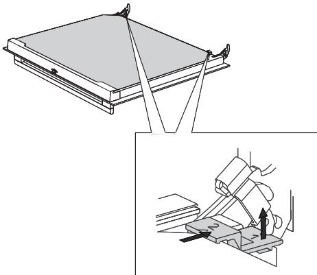
**1** Немного приподнимите фиксаторы с левой и правой стороны дверцы (символ 1 на фиксаторе) и потяните в стороны от стекла (символ 2 на фиксаторе).
