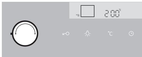
Rotiți BUTONUL SELECTOR DE GĂTIRE la pre-încălzire rapidă. TEMPERATURA PRESETATĂ se va afișa. Această setare de temperatură poate fi ajustată.
