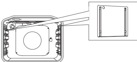
**INSERȚIILE UȘOR DE CURĂȚAT** previn lipirea grăsimii de părțile laterale ale interiorului cuptorului.
