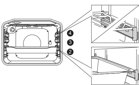
Cu ghidajele telescopice extensibile, scoateți în primul rând ghidajele de pe un nivel și așezați grătarul sau tava de copt pe ele. Apoi, împingeți-le cu mâna cât de mult puteți.
