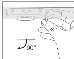
Pentru a reactiva blocarea ușii, deschideți ușa cuptorului și folosiți degetul drept arătător pentru a trage mânerul către dumneavoastră.
