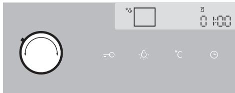
Rotiți BUTONUL SELECTOR AL SISTEMULUI DE GĂTIRE la decongelare. TIMPUL se va afișa. Această setare a timpului poate fi ajustată. Apăsați tasta START.
