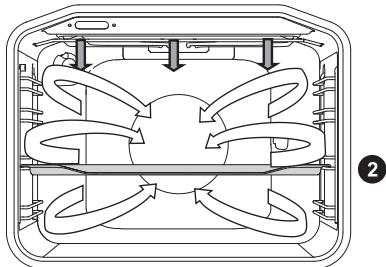
În acest mod de funcționare, încălzitorul grătarului și ventilatorul funcționează simultan. Adevarat pentru prăjirea cărnii, peștelui și a legumelor.
