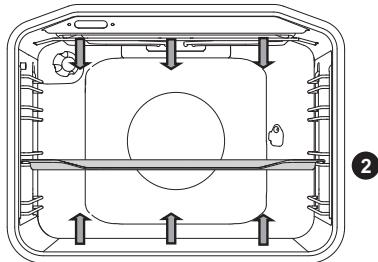
Greli na zgornji in spodnji strani pećice enakomerno oddajata toploto v notranjost pećice.
