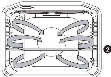
Rezistența rotundă și ventilatorul vor funcționa simultan. Ventilatorul montat pe peretele din spate al cuptorului asigură faptul că aerul cald circulă constant în jurul fripturii sau al produselor de patiserie.
