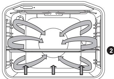
Rezistență inferioară, rezistență rotundă și ventilatorul de aer cald vor funcționa simultan. Corespunzătoare pentru pregătirea pizzai, plăcintelor cu mere și a checurilor cu fructe confiate.
