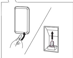
Folosiți o șurubelnită plată pentru a desface capacul becului și a-l scoate. Scoateți becul.
