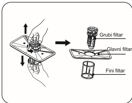
Filtarski sustav sastavljen je iz grubog filtra, ravnog (glavnog) filtra, i mikrofiltra (fini filter).
