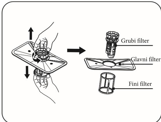
Filterski sistem sastavljen je iz grubog filtera, ravnog (glavnog) filtera, i mikro filtera (fini filter).
