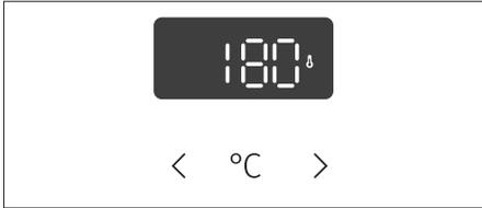
**2** Utilizar las teclas para seleccionar el valor deseado. El ajuste se almacena automáticamente o puede confirmarlo pulsando la tecla °C.
