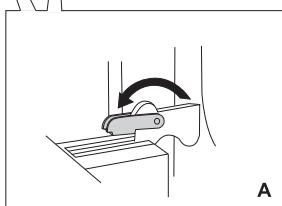
**2 A** Відкиньте фіксатори до кінця назад (при звичайному закриванні дверцят).
