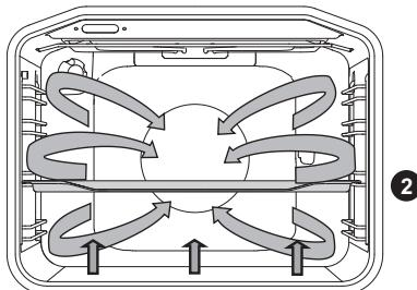
Одночасно працюють нижній нагрівальний елемент, нагрівальний елемент навколо вентилятора і вентилятор.
