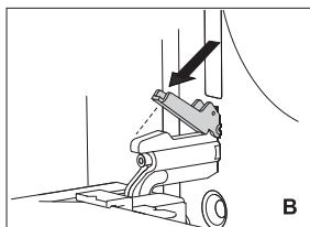
**B** Якщо пристрій обладнано системою GentleClose, оберніть фіксатор дверцят назад на 90° (рис. 2).
