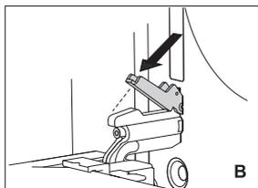
**B** Kod mekanog zatvaranja vrata okrenite odstranjive zasune natrag na 90°(slika 2).
