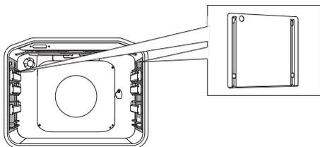
**ULOŠCI ZA JEDNOSTAVNO ČIŠĆENJE** sprječavaju na stranicama pećnice raspršivanje masnoće tijekom pečenja.
