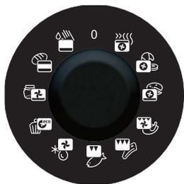
Okretanjem gumba (lijevo i desno) odaberite željeni sustav pečenja ili odabir hrane. Simbol odabranog sustava pečenja svijetli.
