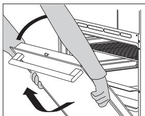
**3** Vrata polagano zatvorite da zasuni nasjednu u svoja ležišta. Lagano ih podignite i izvucite iz oba ležišta šarki na uređaju.
