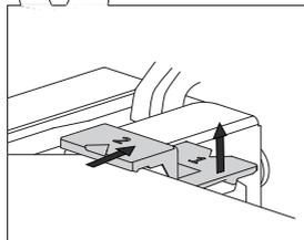
**1** Lagano podignite nosače na lijevoj i desnoj strani vrata (oznaka 1 na nosaču), te ih zatim lagano povucite van iz stakla (oznaka 2 na nosaču).
