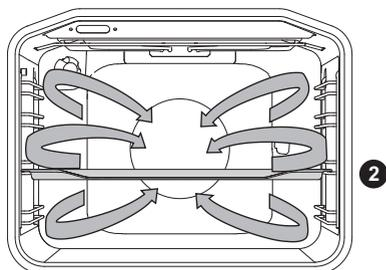
Djeluju okrugao grijač i ventilator. Ventilator na stražnjoj stjenki pećnice brine za stalno kruženje vrućega zraka oko pečenja ili kolača.
