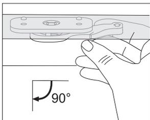
**3** Ako bravu vrata želite ponovno uključiti odnosno aktivirati, otvorite vrata pećnice, i desnim kažiprstom povucite ručicu k sebi.
