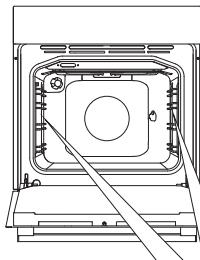
Odstranite žičane odnosno teleskopske vodilice.
