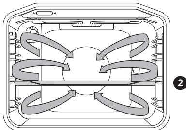
Работат тркалезниот грејач и вентилаторот. Вентилаторот инсталiran на задниот ѕид на перната обезбедува постојана циркулација на топол воздух околу јадењето што се пече или пецивата.
