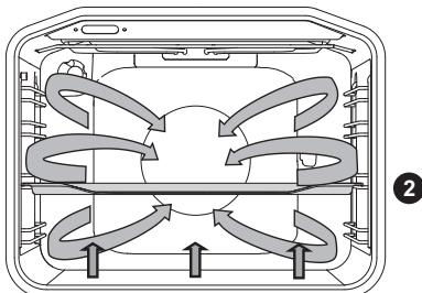
Работат долниот грејач, тркалезниот грејач и вентилаторот за топол воздух. Погодно за печење пица, пита од јаболка и овошни торти.
