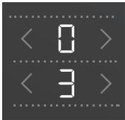
O valor ajustado aparece no mostrador do elemento aquecedor dianteiro direito. Pode ajustar este valor tocando na tecla (H) ou (I) do elemento aquecedor dianteiro direito. Para validar e registar os parâmetros, toque durante 2 segundos a tecla Pausa (F). Ouve-se então tocar um sinal sonoro rápido. Se não quiser registar os novos parâmetros, feche o menu dos ajustes personalizados tocando na tecla Ligar/Desligar.
