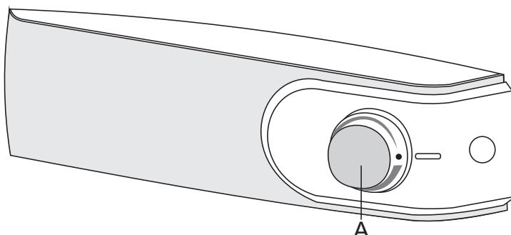
**A Dugme za regulisanje temperature i uključenje/isključenje aparata**
