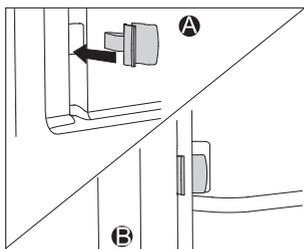
Lorsque vous installez les glissières télescopiques totalement extensibles et les parois catalytiques amovibles, placez une extrémité des clips fournis dans les trous inférieurs situés sur les parois inamovibles du four, puis insérez les tiges verticales des gradins dans l'autre extrémité des clips. Ces derniers servent à maintenir les gradins en fil bien en place.
