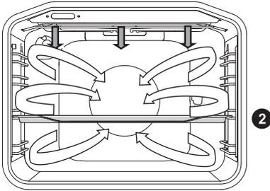
Le gril infrarouge et le ventilateur fonctionnent simultanément. Ce mode convient à la cuisson de la viande, du poisson et des légumes.
