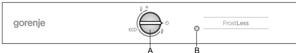
**A Tasto per accendere e spegnere l'apparecchio e per impostare la temperatura nell'apparecchio;** con questo si può attivare anche la funzione ECO e il raffreddamento / congelamento intensivo.
