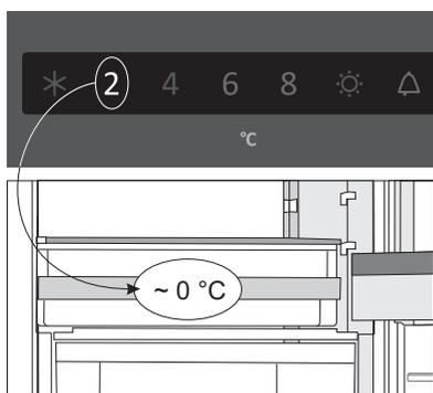
Per rendere la temperatura nel cassetto **ZeroZone** intorno ai 0° C, si raccomanda di impostare la temperatura del frigorifero sotto i 4° C. La temperatura nel cassetto **ZeroZone** può scendere sotto i 0° C, e quindi gli alimenti sensibili al gelo devono essere spostati in un ripiano superiore del frigorifero.
