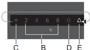
In caso di temperatura troppo elevata all'interno dell'apparecchio si attiva l'allarme acustico (tono interrotto) e lampeggia il simbolo **E**.
