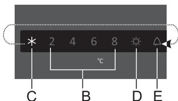
Attivare il congelamento intensivo premendo il tasto **A** più volte fino a quando si illumina il simbolo **C**.
