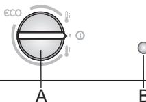
**A Ovládač nastavenia teploty a vypnutia/zapnutia spotrebiča**
