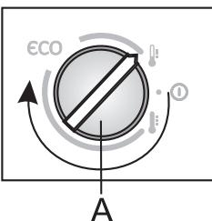
Se a temperatura da peça na qual o aparelho está instalado for inferior a 16°C, recomendamos-lhe de ajustar o botão **A** para o ícone .
