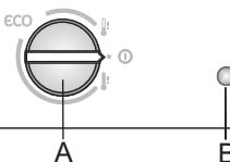
**A Botão do termostato: ajustar a temperatura e Ligar/Desligar**
