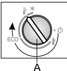
Если температура в помещении, где установлен прибор, ниже +16 °C, рекомендуем установить переключатель А в положение .
