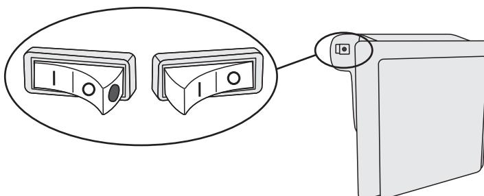
Atunci când ionizatorul este pornit, puteți observa un punct roșu pe comutator.
