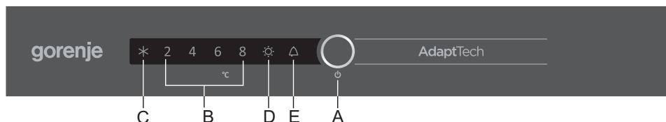
**A Tipka za vklop in izklop aparata ter nastavitev temperature in dodatnih funkcij**
