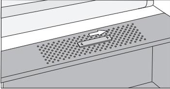
**Liukusäädin oikealla:** tuuletusaukot suljettuina, suurempi kosteus lokerossa.
