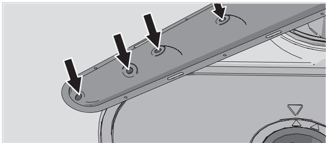
Per facilitare la pulizia è possibile rimuovere i bracci irroratori. Ricordarsi di rimontarli saldamente al loro posto.
