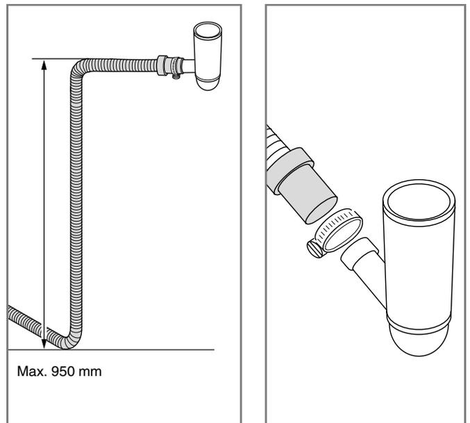
È anche possibile collegare il tubo di scarico a un raccordo sul sifone del lavello. Il raccordo deve avere un diametro interno di almeno 14 mm.
