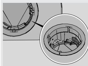
Verificare che il fermo colorato situato a destra del drenaggio inferiore sia al suo posto.
