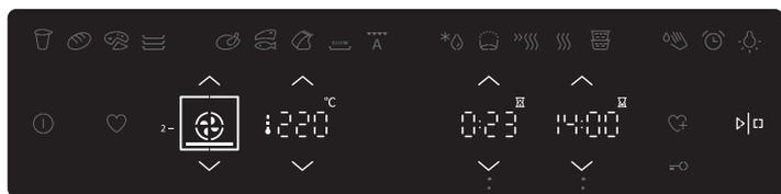
Effleurez les touches (∧) et (∨) pour régler la durée de cuisson.
