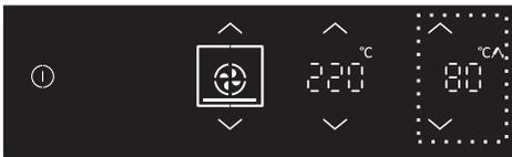
Lorsque la sonde est branchée, le mot "Prob" apparaît à l'écran. Réglez la température voulue. Effleurez la touche DÉPART.
