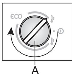
Jos laite on asennettu huoneeseen, jonka lämpötila on alle 16 °C, suosittelemme säätämään valitsimen **A** symboliin .
