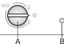
**A Ovládač nastavenia teploty a vypnutia/zapnutia spotrebiča**
