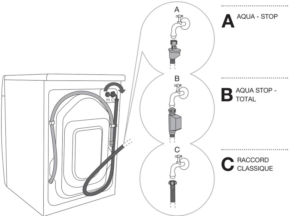
☞ Afin d'assurer le bon fonctionnement de la machine, la pression de l'eau d'arrivée doit être comprise entre 0,05 et 0,8 MPa (0,5 - 8 bar). Vous pouvez vérifier la pression minimale en mesurant l'écoulement de l'eau du robinet. La pression est satisfaisante si 3 litres d'eau s'écoulent en 15 secondes du robinet ouvert à fond.
