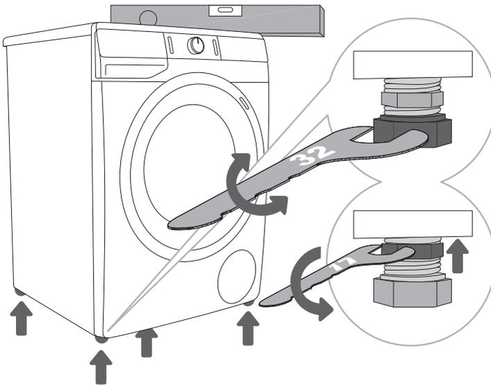
**1** Mettez l'appareil à niveau dans le sens longitudinal et le sens transversal en tournant les pieds réglables.
