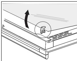
**3** Чтобы снять внутреннее третье стекло (в некоторых моделях), приподнимите его и снимите. Снимите также прокладки со стекла.
