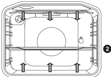
Верхний и нижний нагревательные элементы равномерно излучают тепло внутрь духовки.
