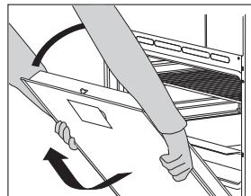
**3** Медленно закрывайте дверцу, пока фиксаторы не упрются в прорези на дверце. Немного приподнимите дверцу и извлеките из гнезд шарниров. Устанавливайте дверцу в обратном порядке. Если дверца не открывается / закрывается правильно, проверьте, правильно ли выемки на шарнирах сели в гнездах.
