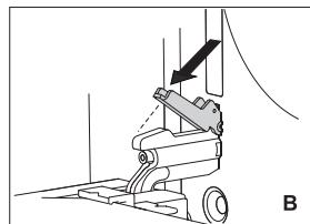
**B** Откиньте фиксаторы назад на 90° (при плавном закрывании дверцы, рис. 2).
