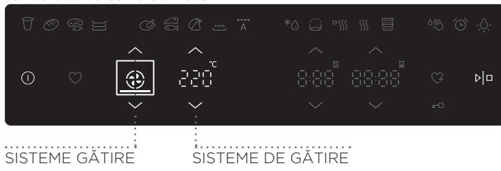
Apăsați tasta **( $\wedge$ )** și **( $\vee$ )** pentru a selecta modul/sistemul de gătire și temperatura cuptorului.
