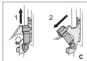
**C** При плавном закрывании дверцы приподнимите фиксаторы и потяните на себя.
