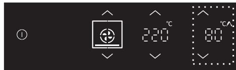
После подключения зонда на дисплее загорится надпись **Prob**. Установите температуру зонда. Нажмите на сенсор СТАРТ.
