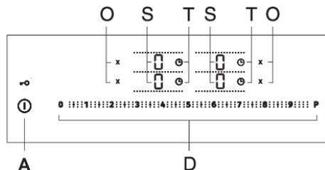
Colocar el recipiente sobre la placa de cocción. Presionando el botón de encendido/apagado (A) se enciende la placa de cocción. En todos los visualizadores de las zonas de cocción (S) aparece "0". Se oye una señal acústica corta.
