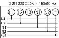
Conexión monofásica (1 1N, 220-240 V~/ 50/60 Hz):
