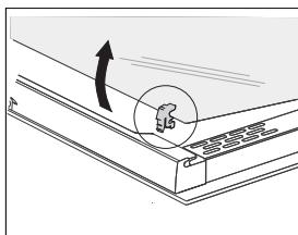
**3** Ak chcete odstrániť tretiu sklenenú tabuľu (iba pri niektorých modeloch), nadvihnite ju a odstráňte. Tiež odstráňte gumové tesnenia na sklenenej tabuli.
