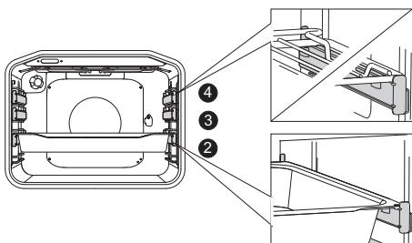
S teleskopickými rozšíriteľnými lištami, najsú vytiahnite lišty na jednu úroveň a umiestnite na ne plech. Potom ich zatlačte na doraz.
