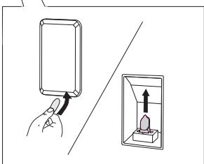
Pomocou plochého skrutkovača uvoľnite kryt žiarovky a odstráňte ho. Vyberte žiarovku.
