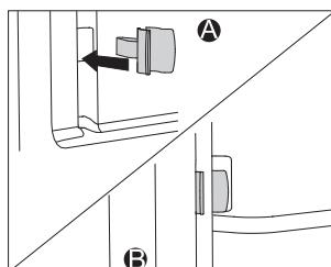
Pri inštalácii plne vysúvacích vodítok s katalytickými vložkami, vložte jeden koniec dodanej úchopnej zámky do otvoru v dolnej časti vnútra rúry a vložte druhý koniec úchytnej zámky do vodítok. Účelom úchopných zámkov je držať vodítka pevne na mieste.
