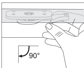
Ak chcete opäťovne aktivovať zámok dverí, otvorte dvere rúry a pomocou pravého ukazováka vytiahnite páčku smerom k vám.
