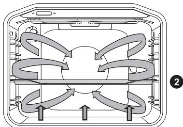
Dolné ohrevné teleso, okrúhle ohrevné teleso a teplovzdušný ventilátor pracujú. Vhodné na pečenie pizze, jablkového koláča a ovocného koláča.
