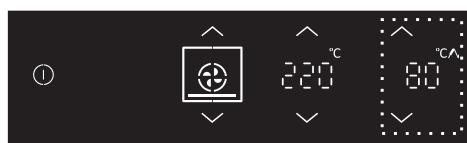
Ako náhle je sonda pripojená, na displeji sa zobrazí "Prob". Nastavte požadovanú teplotu. Stlačte tlačidlo START.
