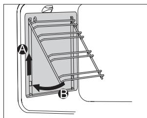
**2** Zaveste vložky s vodítkami pripojenými pomocou pripravených otvorov a zatlačte smerom nahor.
