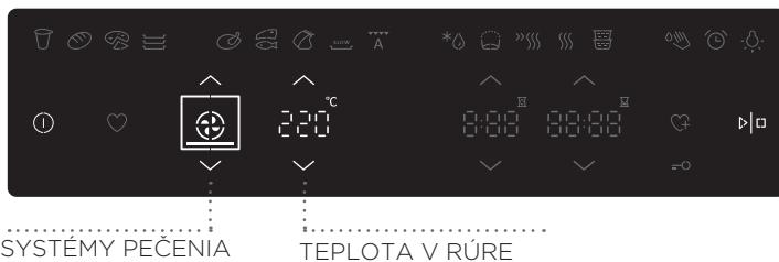
Režim/systém pečenia a teplotu v rúre zvolíte pomocou tlačidiel ( $\nearrow$ ) a ( $\searrow$ ).
