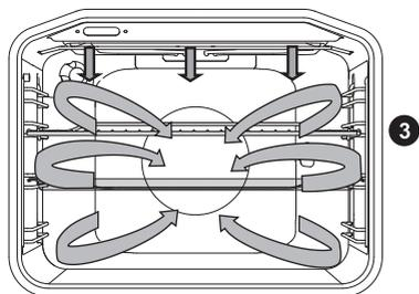
Одновременно работают верхний нагревательный элемент, инфранигреватель и нагревательный элемент вокруг вентилятора. Используется для приготовления всех видов мяса.
