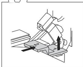
**1** Немного приподнимите фиксаторы с левой и правой стороны дверцы (символ 1 на фиксаторе) и потяните в стороны от стекла (символ 2 на фиксаторе).
