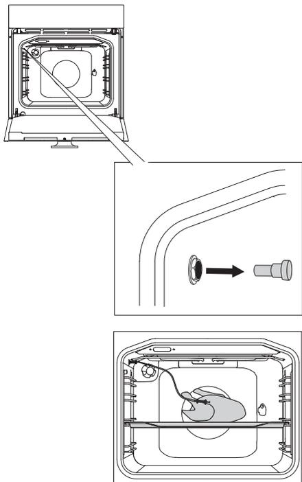
**1** Выньте металлическую заглушку (гнездо для зонда расположено в переднем верхнем углу на правой стенке духовки).
