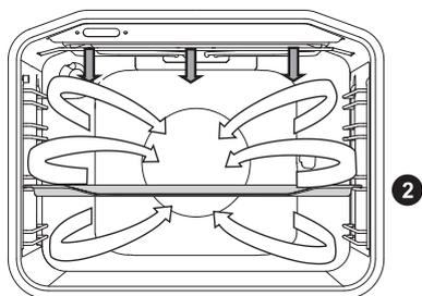
Одновременно работают верхний нагревательный элемент, инфранигреватель и вентилятор.
