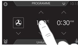
1. Tippen Sie auf die Mitte des Funktionssymbols, der Temperatur, der Leistung oder der Garzeit (aktiviert). Die Tastatur wird angezeigt.
