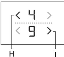
Auf jeder Kochzone können 9 oder 17 verschiedene Kochstufen eingestellt werden. Bei 17 Kochstufen stellt der Punkt auf der Kochstufenanzeige eine halbe Stufe dar (z.B. 8 = 8,5, vom Modell abhängig).
