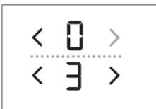
Der aktuell eingestellte Parameterwert erscheint auf den rechten Kochzonen-Leistungsstufen-Anzeigen. Der Wert kann durch Drücken der Tasten (H) oder (I) für die Kochzone angepasst werden. Alle Parameter können durch Drücken der Pausetaste (F) und 2 Sekunden langes Halten bestätigt und gespeichert werden. Dann ertönt ein kurzer Piepton. Wenn Sie die neuen Parametereinstellungen nicht speichern möchten, schließen Sie den Benutzereinstellungsmodus durch Drücken der Ein/Aus-Taste.
