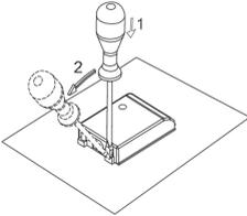
Die Verbindungsbrücken sind an der dafür vorbereiteten Stelle in der Klemme abgelegt.
