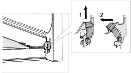
3. Медленно закрывайте дверцу, немного приподнимите ее и извлеките из гнезд шарниров.
