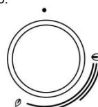
Мощность нагрева обозначена на переключателях символами большого и малого пламени. Вращайте переключатель через положение большого пламени (○) до положения малого пламени (0) и обратно. Рабочее положение находится между символами большого и малого пламени.
