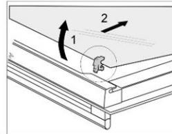
Возьмите стекло дверцы за нижний край, немного приподнимите, чтобы оно освободилось из фиксаторов, и снимите.
