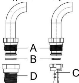
А Трубка газопровода EN ISO 228-1
