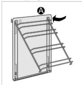
Наденьте вкладыш на направляющие: вставьте прутья направляющих в отверстия в верхней части вкладышей "A".
