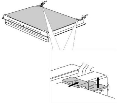
Немного приподнимите фиксаторы с левой и правой стороны дверцы (символ 1 на фиксаторе) и потяните в стороны от стекла (символ 2 на фиксаторе).
