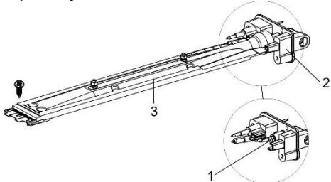
При настройке горелки духовки на другой вид газа снимите панель управления, выдвижное дно и горелку духовки (открутите винты в передней части горелки и немного потяните горелку вперед).
