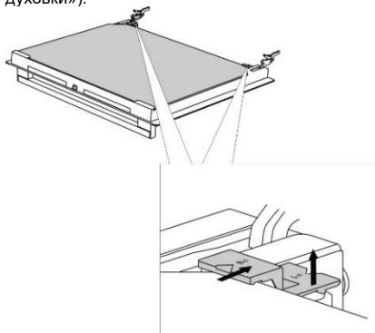
Немного приподнимите фиксаторы с левой и правой стороны дверцы (символ 1 на фиксаторе).
