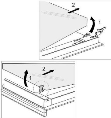
Возмите стекло дверцы за нижний край, немного приподнимите, чтобы оно освободилось из фиксаторов, и снимите.
