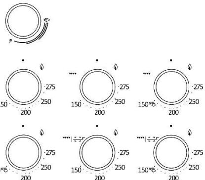
Подача газа к горелке духовки регулируется газовым клапаном или термостатом с газ-контролем.
