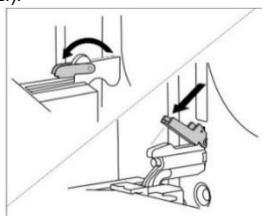
3. Медленно закрывайте дверцу, пока фиксаторы не упрются в прорези на дверце. Приблизительно при 15° (относительно закрытой дверцы) дверцу немного приподнимите и извлеките из гнезд шарниров.
