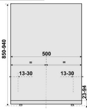
Закрепите кронштейн на стене с помощью прилагаемых в комплекте винтов и дюбелей. Если прилагаемые винты и дюбели не обеспечивают надежный монтаж кронштейна, используйте другой крепеж, обеспечивающий надежную фиксацию кронштейна.
