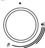
Мощность нагрева обозначена на переключателях символами большого и малого пламени. Вращайте переключатель через положение большого пламени (�) до положения малого пламени (�) и обратно. Рабочее положение находится между символами большого и малого пламени.
