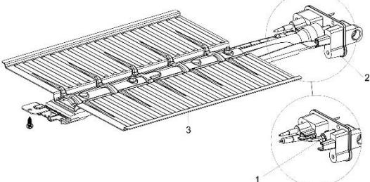
При настройке инфрагорелки на другой вид газа снимите инфрагорелку (открутите винт в передней части инфрагорелки и немного потяните инфрагорелку вперед).
