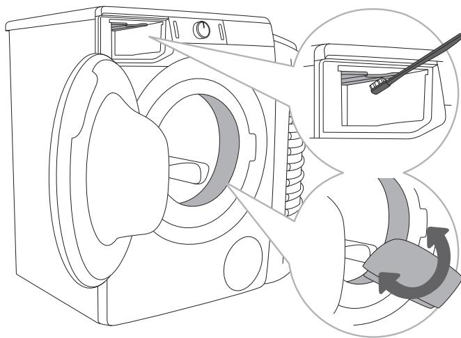
**1** Очистите щёткой отсек дозатора, особенно форсунки в верхней части отсека.
