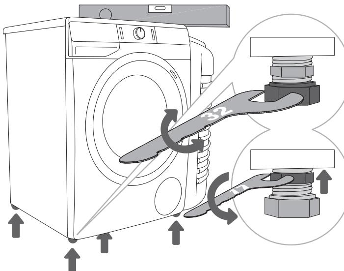
**1** Машину выставьте по уровню строго горизонтально, выворачивая или вворачивая регулируемые ножки.
