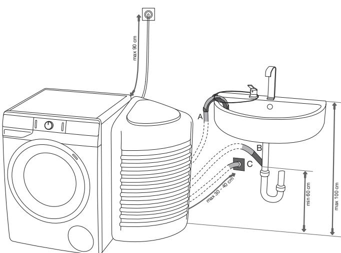
**C** Подсоедините сливной шланг во встроенную в стену сточную трубу с сифоном, который имеет возможность очистки.
