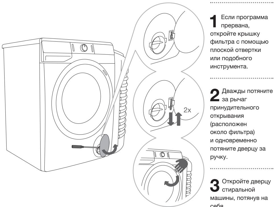
**1** Если программа прервана, откройте крышку фильтра с помощью плоской отвертки или подобного инструмента.
