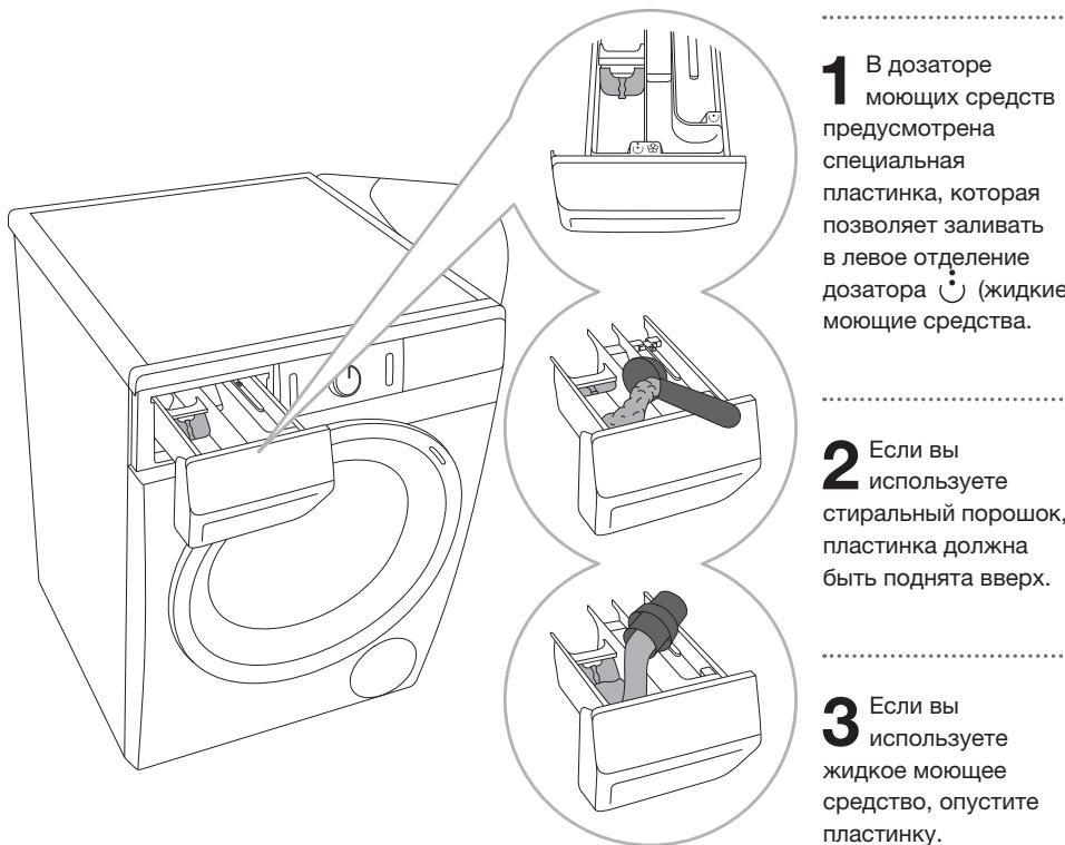
**1** В дозаторе моющих средств предусмотрена специальная пластина, которая позволяет заливать в левое отделение дозатора (жидкие моющие средства).
