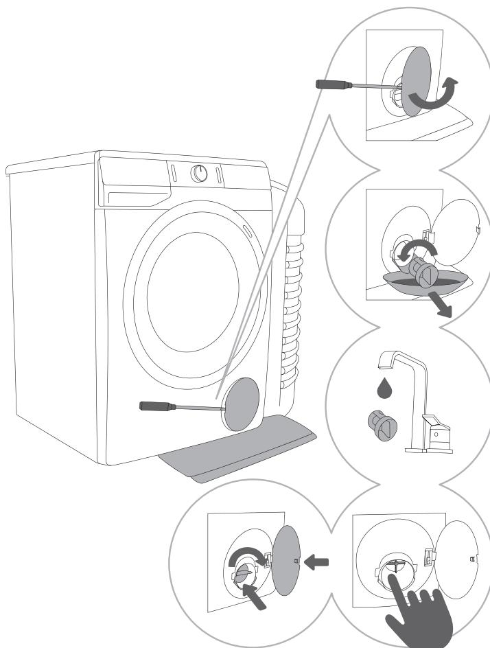
**1** Откройте крышку Фильтр насоса с помощью плоской отвертки или подобного инструмента.
