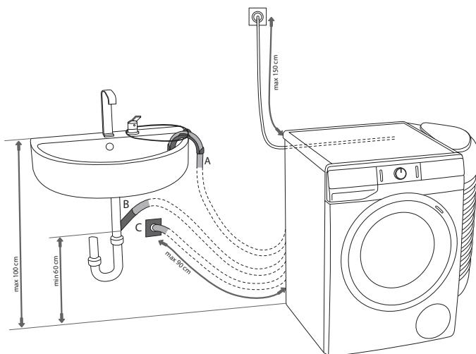
**A** Закрепите сливной шланг на раковине или ванне. Потяните шнур через пластмассовый кронштейн и закрепите сливной шланг так, чтобы он не соскальзывал на пол.
