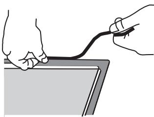
Выполните присоединительный кабель вниз через монтажный проем. Установите варочную панель по центру монтажного проема. Подключите прибор к электросети (см. раздел «Подключение к электросети») и проверьте его работу перед прокладкой герметика.
