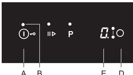
Чтобы выключить варочную панель, нажмите на сенсор ВКЛ./ВЫКЛ. (A). Раздастся звуковой сигнал, все индикаторы и дисплеи погаснут, кроме дисплеев конфорок, которые еще остаются горячие. На этих дисплеях будет гореть символ **H**.
