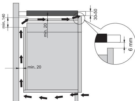
**РАЗМЕРЫ МОНТАЖНОГО ПРОЕМА** (в зависимости от модели)
