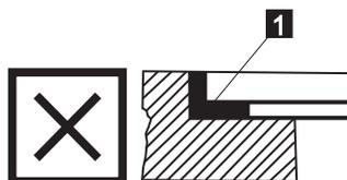
1. Mastic au silicone, 2. Joint d'étanchéité en ruban
