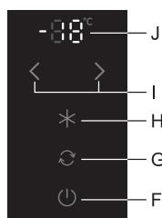
**Изключване на уреда:** За да изключите уреда, натиснете и задръжте (за три секунди) бутон **F** (внимание: уредът ще остане включен към електрическата мрежа, т.е. в него ще продължи да тече електрически ток).
