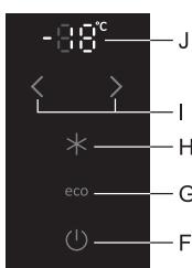
**Изключване на уреда:** За да изключите уреда, натиснете и задръжте (за три секунди) бутон **F** (внимание: уредът ще остане включен към електрическата мрежа, т.е. в него ще продължи да тече електрически ток).
