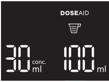
6. Aufgrund der gemessenen Menge der Wäsche in der Trommel und aufgrund der durchgeführten Einstellungen wird auf dem Display die empfohlene Menge des Waschmittels angezeigt (Waschpulver oder Flüssigwaschmittel). Auf dem linken Display wird die empfohlene Menge des konzentrierten Waschmittels angezeigt, auf dem rechten Display wird die Menge des nichtkonzentrierten Waschpulvers oder Flüssigwaschmittels angezeigt.
