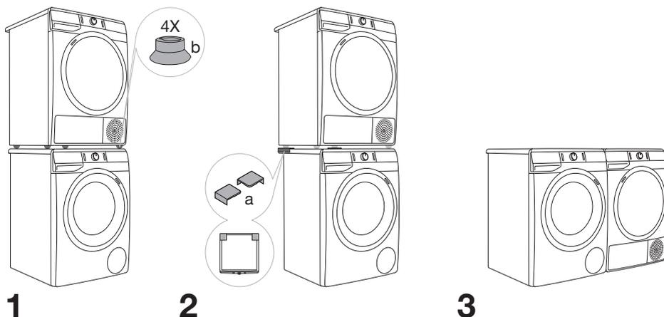
⚠ Die Aufstellung des Wäschetrockners auf die Waschmaschine soll von mindestens zwei Personen durchgeführt werden.
