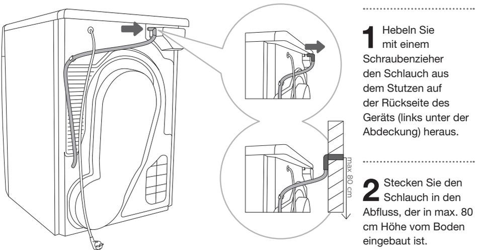
☼ Falls Sie den Schlauch für die Ableitung des Kondenswassers in einen Abfluss stecken sorgen Sie dafür, dass der Schlauch gut befestigt ist. Damit wird ein eventuelles Ausfließen des Kondenswassers verhindert, was unerwartete Schäden verursachen könnte.
