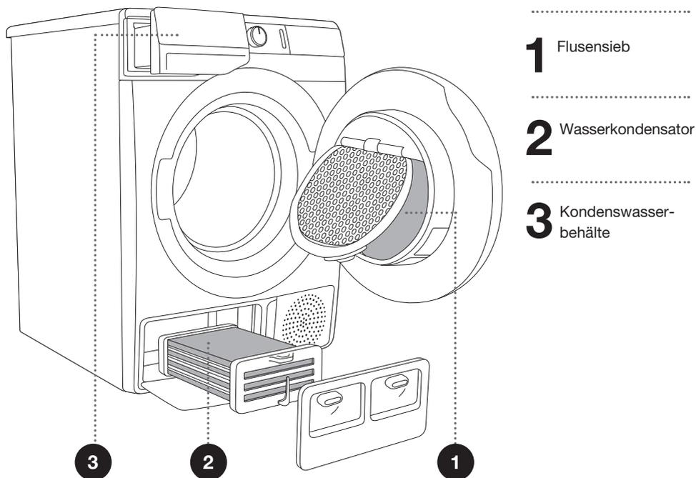
⚠ Der Wäschetrockner darf niemals ohne Filter oder mit einem beschädigten Filter betrieben werden, da die angesammelte übermäßige Menge an Unreinheiten (Fasern) eine Beschädigung oder Störung des Geräts verursachen würde.
