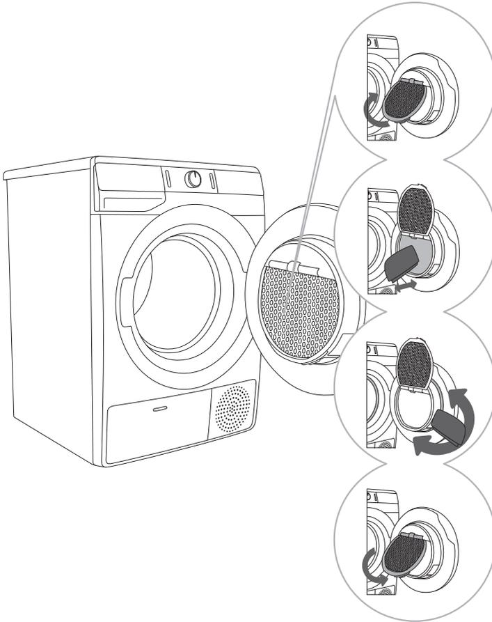
**1** Heben Sie die Filterabdeckung an.
