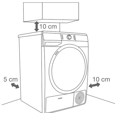
☞ Das Gerät darf die Wand oder die benachbarten Küchenelemente nicht berühren. Für eine optimale Funktion des Wäschetrockners empfehlen wir, den Abstand zur Wand zu berücksichtigen, wie es auf der Abbildung dargestellt ist. Bei Nichtbeachtung der Minimalabstände besteht die Gefahr der Überhitzung des Geräts.
