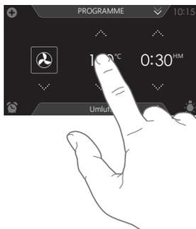
1. Tippen Sie auf die Mitte des Funktionssymbols, der Temperatur, der Leistung oder der Garzeit (aktiviert). Die Tastatur wird angezeigt.
